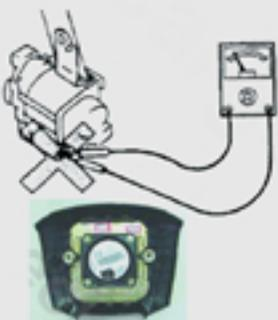
۶- استفاده از مولتی متر جهت تست مدول ایربگ و یا پیش کشنده کمر بند ایمنی بسیار خطرناک است و ممکن است آسیب جدی به شخص برساند. لذا جهت عیب یابی از دستگاه عیب یاب استفاده کنید.
