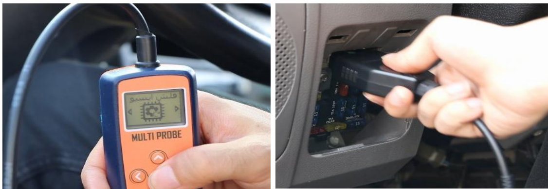
اتصال به سوکت OBD خودرو و انجام فلش ایسیو
