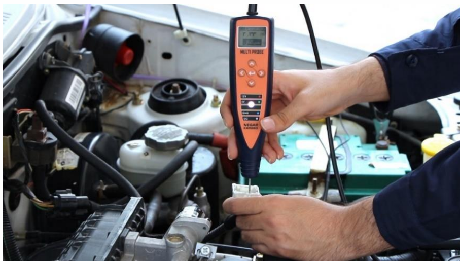
تست پایه‌های سنسور دریچه گاز
