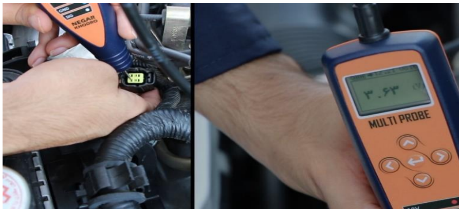
تست سنسور اکسیژن
