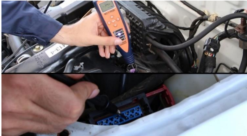
تست سیم کشی تغذیه انژکتور تا رله دابل
